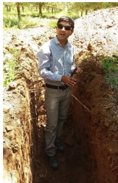
Foto N° 14: Calicata para estudio de suelo.
